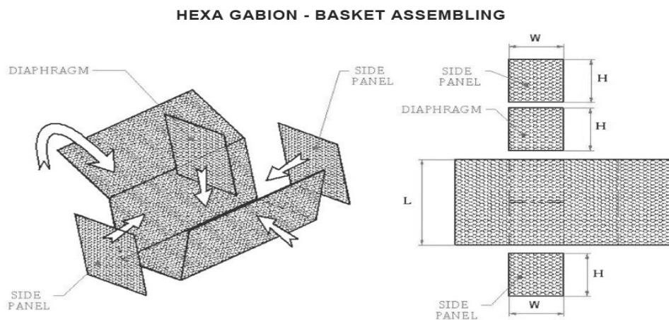
**Габионски кавези су правоугаоног облика,** дужине  $2,0\text{м}$ ; висине  $1,0\text{м}$  и ширине  $1.0\text{ м}$ .
